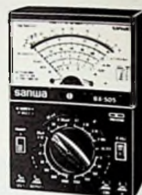
Polariteit- schakelaar BX/505 Meetbereiken: DCV, DCA, ACV, Ohm, DB, ACA.
